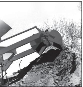
Autocaricatore del tipo benna mordente, consente di caricare ogni volta un volume costante di materiale. Unito al telaio articolato consente di caricare in spazi ristretti, a macchina ferma, evitando l'usura della trasmissione e l'affaticamento dell'operatore.
