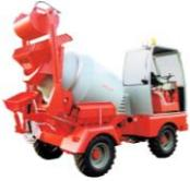
**5.1 Transport Attention !!** Les bétonnières portées sont livrées avec 2 roues démontées, Lorsqu'elle doit être déchargée du conteneur, **arranger un plan au niveau du même conteneur**, afin d'éviter d'endommager la machine. Le toit ou la cabine sont livrés démontés, de sorte qu'il suffit de les monter, relier le clignotant avec le connecteur spécial, tourner le coupe-batterie à la position ON (car il avait été réglé sur OFF pour le transport) et faire le plein de carburant.
