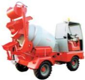
**5.1 Transporte Atención !!** Las autohormigoneras se envían con 2 ruedas desmontadas, para descargarlas del Container, **buscar un plan al mismo nivel de Container**. En caso contrario, la máquina podría dañarse. El techo o la cabina son desmontados, por lo que es suficiente montarlos, conectar el indicador con el conector apropiado, gire el interruptor de la batería a la posición ON (debido a que el transporte se establece en OFF) y abastecerse de combustible.
