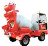
**4.1 Descripción de la máquina** Los camiones hormigoneros son máquinas fabricadas para el sector de la construcción; los diseña, fabrica, ensaya y vende la empresa Silla. Estas máquinas están concebidas para: la carga de los inertes, la mezcla y el transporte del hormigón, en la obra.
