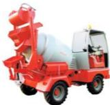
**4.1 Description du camion malaxeur** Les camions malaxeurs sont conçus pour les chantiers de construction, et ils sont projetés, produits, testés et vendus par SILLA. Ils sont conçus pour le chargement de matériaux inertes, pour mélanger et transporter le béton dans les chantiers de construction. Ils ont la
